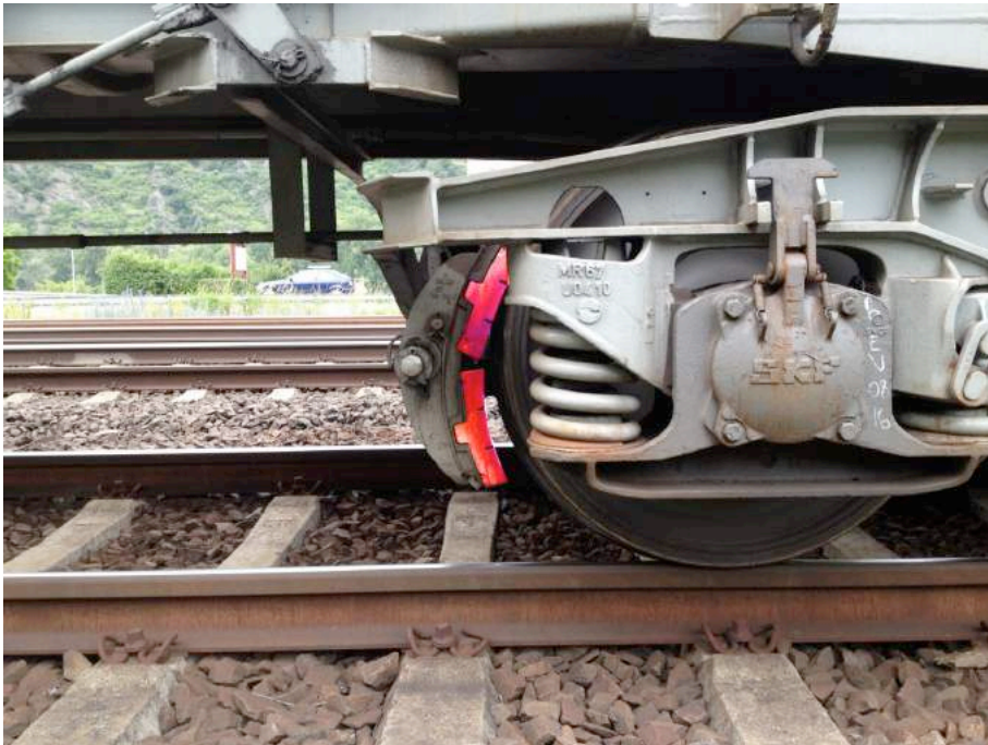
Bild 2: Neue Bremsklötze (hier rot gekennzeichnet) sind in wenigen Minuten umgerüstet und werden vom Staat bezahlt und von der EU bezuschusst. Doch die Waggonbesitzer wollen mehr und scheren sich wenig um das Leid der Menschen!
