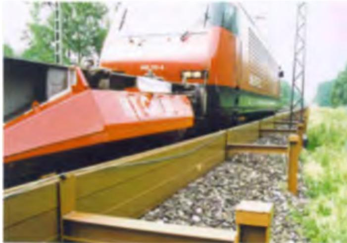
Schürzen am Waggon in Kombination mit niedrigen Schallschutzwänden
